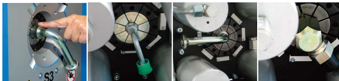
Hydraulik-Zylinder stellen kein Hindernis dar, um rückseitig auch gebogene Armaturen einfach zu verpressen.
